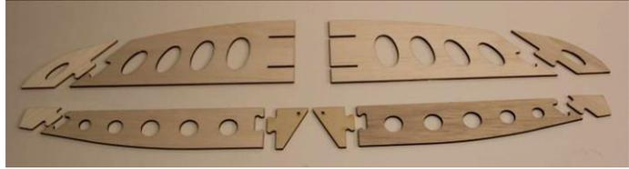
Durch das Stecksystem entsteht eine stabile Zelle, was dem Rumpf eine ausgezeichnete Stabilität verleiht.
