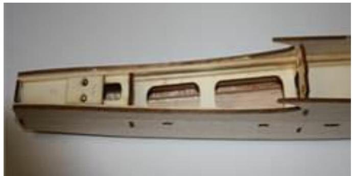
Zur Verstärkung der Flügelbefestigung wird eine 0.5mm GFK Verstärkung angeleimt. Die Übergänge sollten aus optischen Gründen verschliffen werden.
