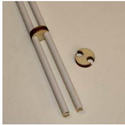
Es ist darauf zu achten das **möglichst gerade** Verleimt wird, da das Einfahren in das Kohlerohr sonst problematisch werden könnte. Dann noch beidseitig Sekundenleim an die Pappelringe.
